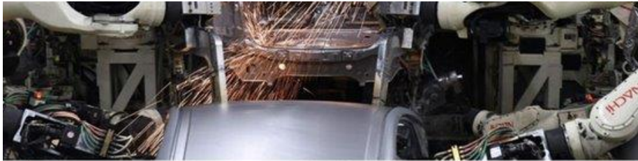
▲ Robotarmen bezig met laswerkzaamheden aan een Toyota Prius. © AFP
